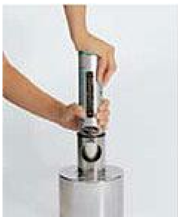
شکل 41- نحوه کالیبراسیون چکش اشمیت معمولی و شاقولی
